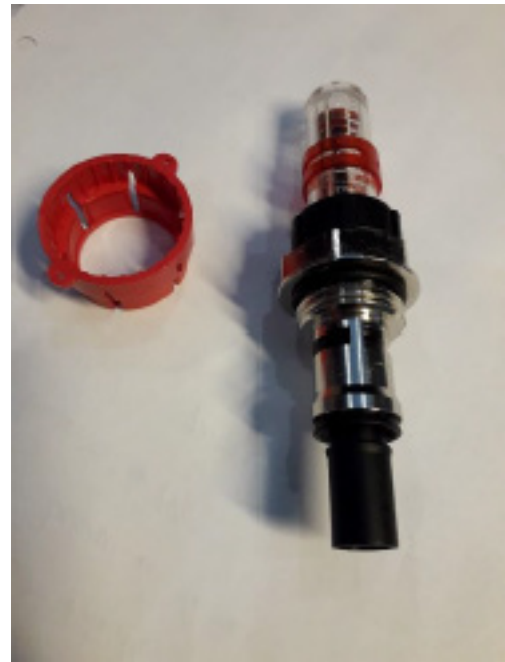
Kuva 1. Irroita virtausmittarin punainen lukituskappale. Kuva 2. Lukituskappale irroitettuna
