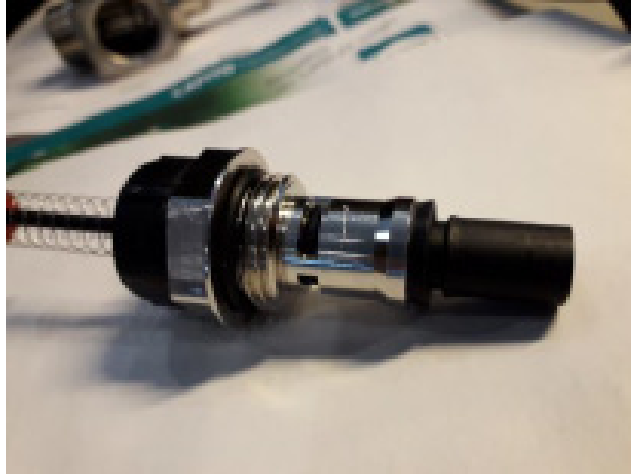
Kuva 4. Jos koko virtausmittari päätetään vaihtaa, voidaan se irrottaa jakotukista virtausmittarin rungosta vastapäivään kiertämällä. Liitos on O-rengas tiivisteinen. Uusi virtausmittari voidaan asentaa paikoilleen kiertämällä se kiinni.
