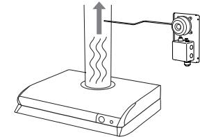
2 Borra ett hål på Ø8 mm i fläktens utloppskanal och fäst tryckuttaget med pilen i samma riktning som luftflödet i kanalen.
