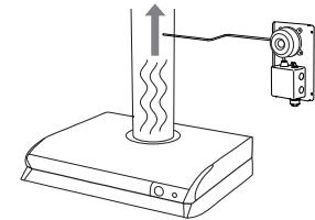
2 Poraa läpimaltaan 8 mm:n reikä kanavaa ja kiinnitä painelähtö siten, että lähtöön merkitynuoli vastaa kanavan virtaussuuntaa.
