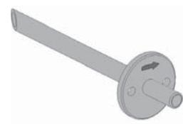
3 Liitä letku tämän jälkeen painelähdön ja painevahdin väliin kuten kuvassa. Tämä on tärkeää oikean toiminnan varmistamiseksi. Painekytimen miinuslitintä ei saa käyttää.
