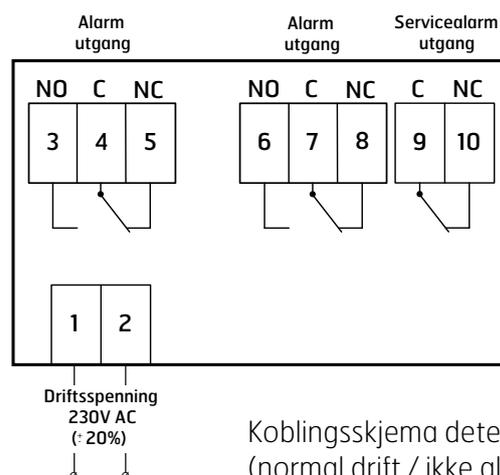
Koblingsskjema detektor (normal drift / ikke alarm)
