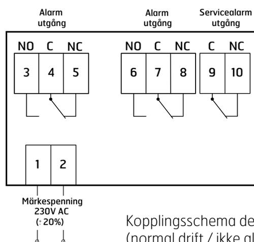
Kopplingschema detektor (normal drift / ikke alarm)
