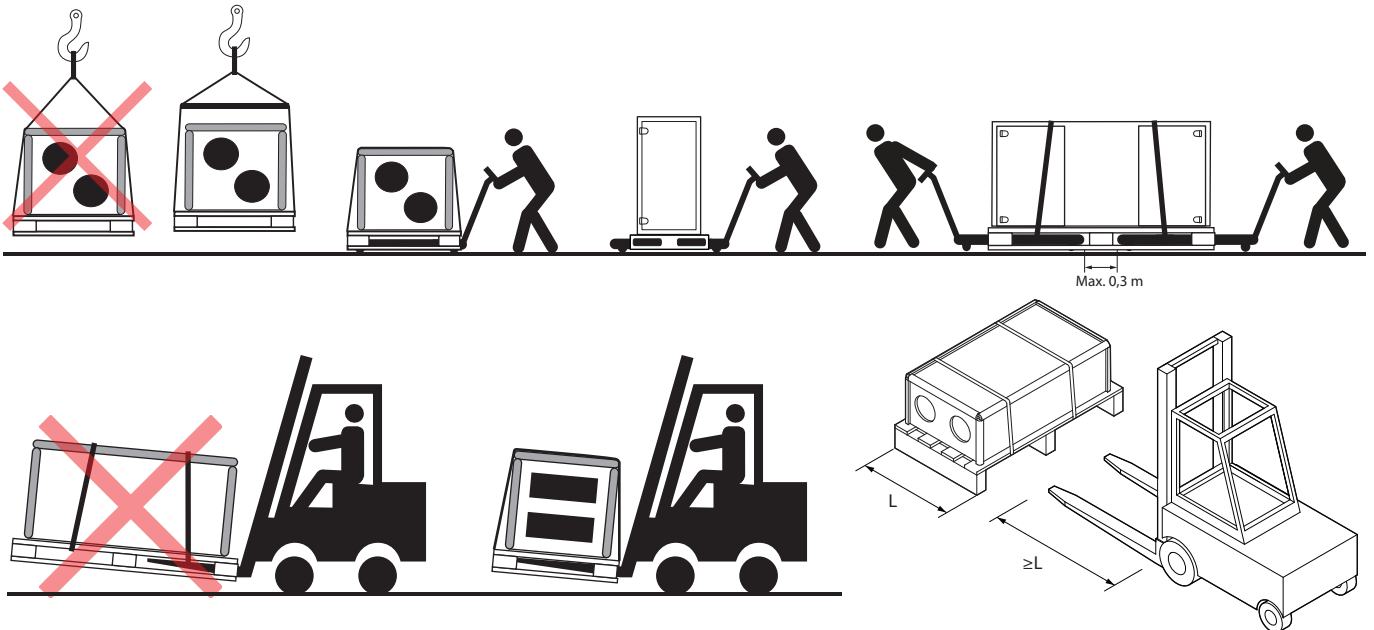
Kuva 5. Esimerkkejä koneen kuljettamisesta nosturilla, haarukkatrukilla ja käsitruckilla
