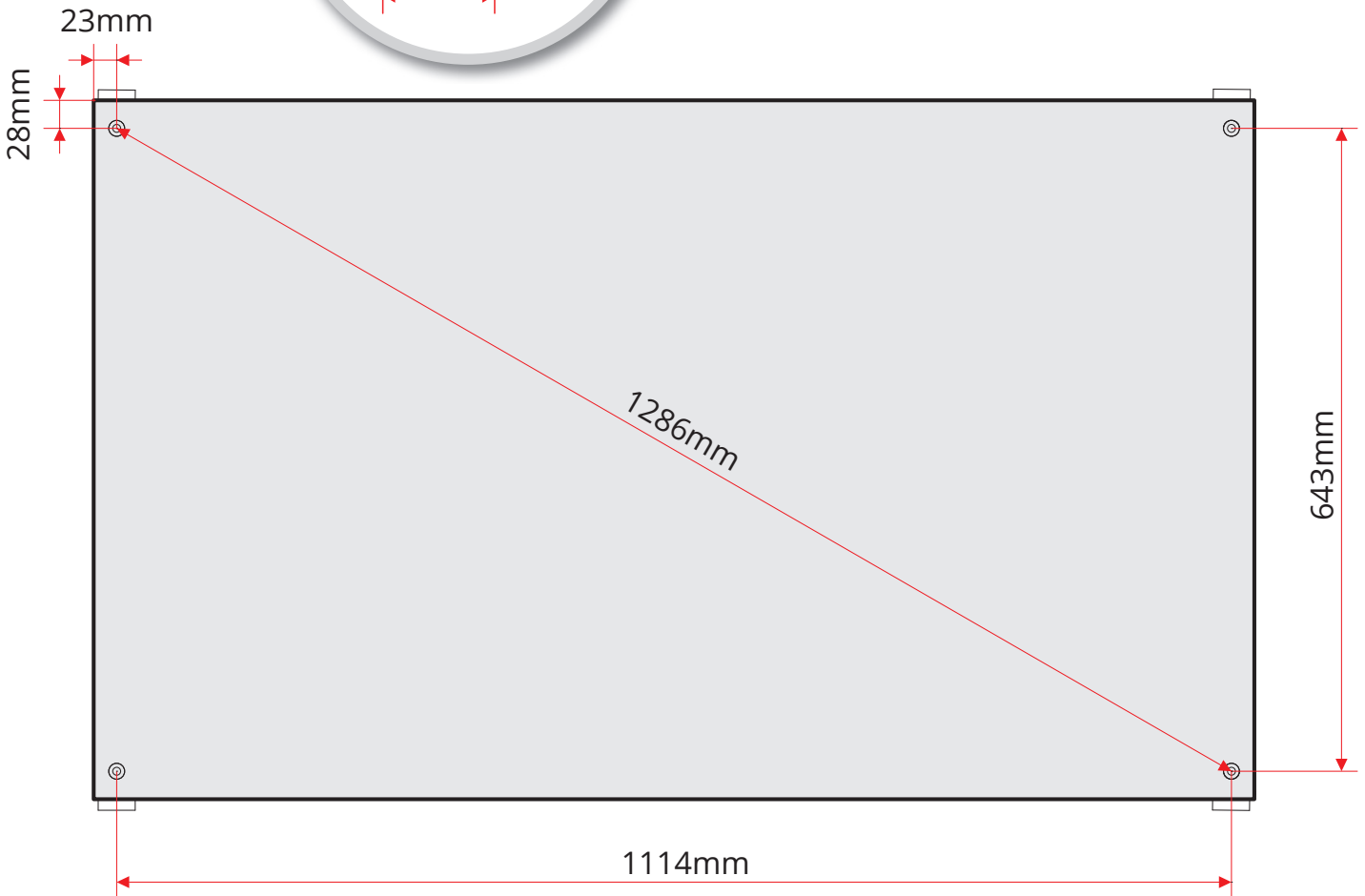
Kuva 5: Reikien poraaminen, asennus ylös
