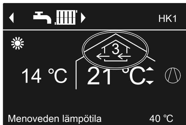
Kuva. 23 Esimerkki ilmanvaihdosta käyttöohjelmalla "Ilmanvaihtoautomaatiikka" käyttötilalla "Normaali"
