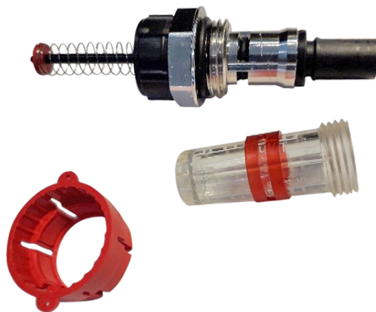
Kuva 3. Irroita virtausmittarin läpinäkyvä kupu kiertämällä sitä vastapäivään. Tarkasta virtausmittarin toiminta painamalla virtausmittarin näytintä alaspäin jakotukin suuntaan. Jos virtausmittarin näyttö ei liiku jouhevasti on virtausmittari syytä vaihtaa. Roskat ja epäpuhtaudet saattavat tukkia virtausreitit ja näyttöä alaspäin painamalla saadaan mahdollinen lika liikkeelle.
