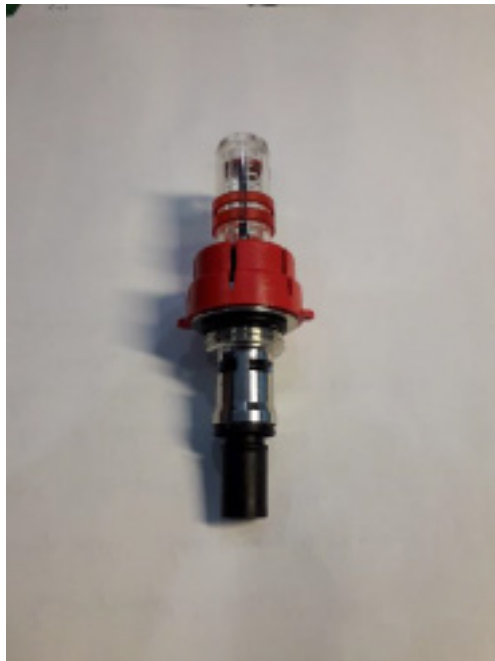
Kuva 1. Irroita virtausmittarin punainen lukituskappale. Kuva 2. Lukituskappale irroitettuna
