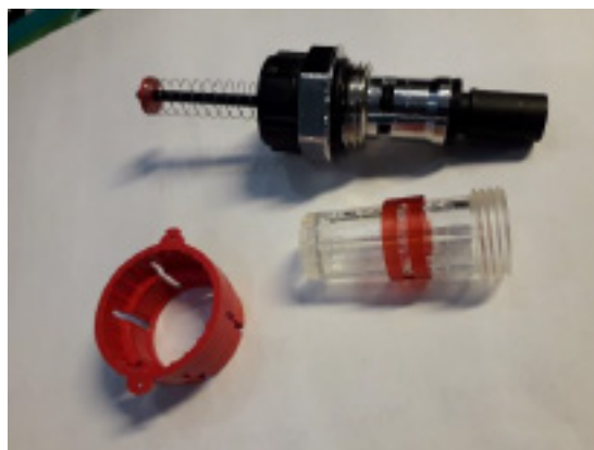
Kuva 3. Irroita virtausmittarin läpinäkyvä kupu kiertämällä sitä vastapäivään. Tarkasta virtausmittarin toiminta painamalla virtausmittarin näytintä alaspäin jakotukin suuntaan. Jos virtausmittarin näyttö ei liiku jouhevasti on virtausmittari syytä vaihtaa. Roskat ja epäpuhtaudet saattavat tukkia virtausreitit ja näyttintä alaspäin painamalla saadaan mahdollinen lika liikkeelle.
