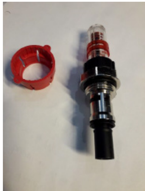
Kuva 1. Irroita virtausmittarin punainen lukituskappale. Kuva 2. Lukituskappale irroitettuna
